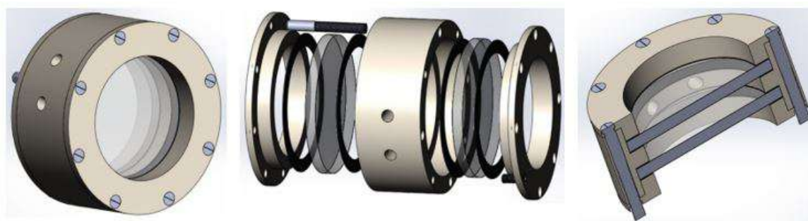
Рисунок 1. Общий вид блока светового проема солнечного термохимического реактора
