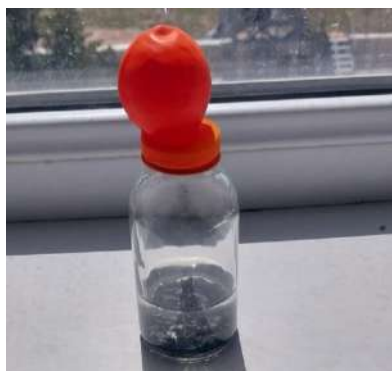
Рисунок 2. Фото стеклянного сосуда с водой, катализатором, выставленного на свет
